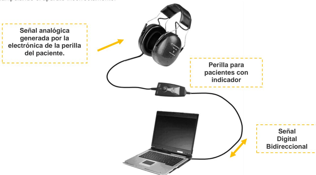
En la perilla de respuesta, el DSP (Digital Signal Processor) asegura la comunicación con el ordenador y la generación de sonidos.
