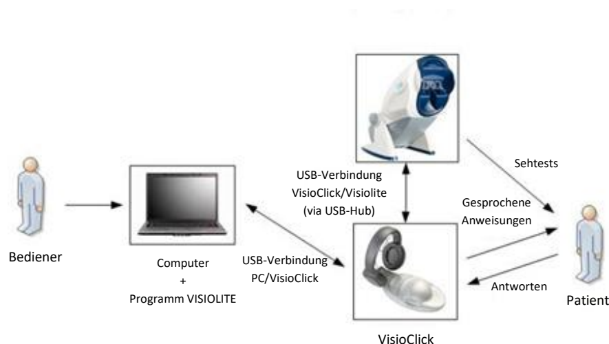
Abbildung 3 Schematische Darstellung der Funktionsweise des VisioClick®
