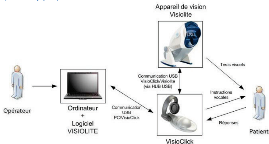
Εικόνα 3 Σχεδιάγραμμα του τρόπου λειτουργίας του VisioClick®
