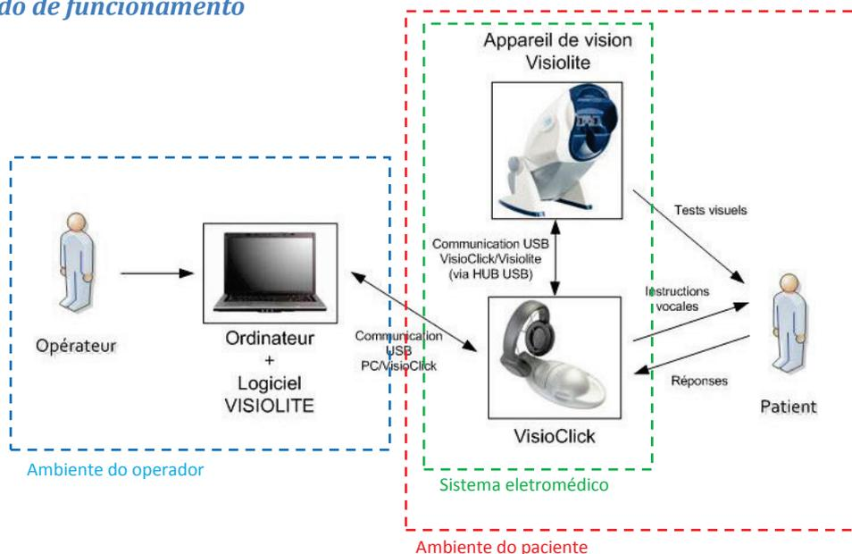
Figura 3 Esquema do modo de funcionamento do VisioClick®
